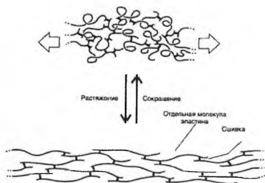
Рис. 1. Молекулы эластина связаны ковалентными сшивками
